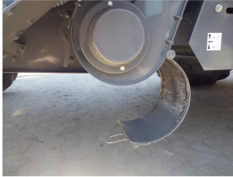
Der Feuchtigkeitssensor wird an die Klappe des Körnerelevators montiert. Dafür benötigtes Montagewerkzeug wird hier kurz aufgelistet:
